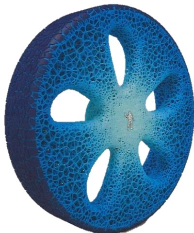
Ce pneu Michelin , dont la structure alvéolaire est inspirée des coraux, est increvable puisque sans air. De plus, sa bande de roulement, reformable par impression 3D, lui confère une très longue durée de vie. Pneus, poids réduisent de 15 à 25% les émissions de CO 2 des véhicules
