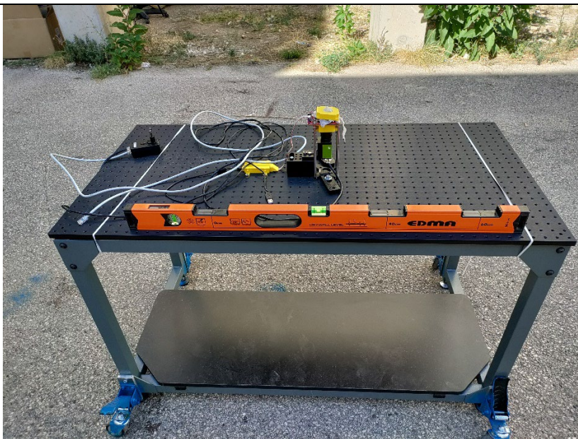
Figure 1. Table optique Thorlabs de précision mobile permettant de pointer à la verticale avec une précision de 0,03^\circ la caméra SONY UV, rendue polarimétrique au moyen d'un filtre polarisant rotatif.
