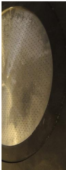
Fig. 1 : Exemple de MPP étudié en soufflerie à IRPHE, diamètre des trous 500 \mu\text{m} .
