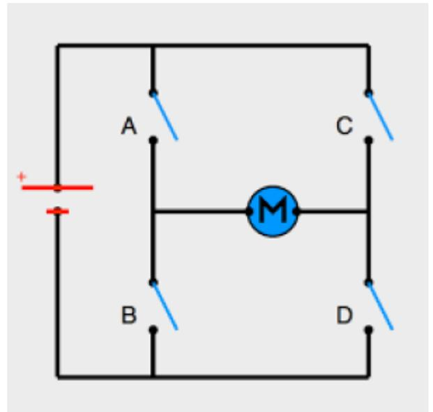
Un pont en H est un montage électronique servant à contrôler le sens du courant et de la tension aux bornes d'un dipôle. Il permet notamment de contrôler le sens de rotation d'un moteur à courant continu.
