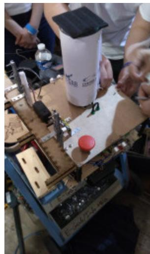
Construit sur une base roulante holonome, **Schyzo** utilisait une pince en forme de peigne pour attraper trois palets et les déposer dans l'accélérateur de particules. Un cramege inopiné de notre système de contrôle la veille de la compétition nous a néanmoins contraint à revoir à la baisse nos attentes. Dès lors, Schyzo récupérait les palets disposés sur la table et les rangait dans la case rouge du tableau de Mendeleïev.
