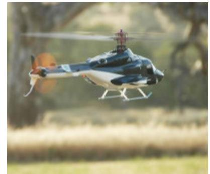
Propulsé par un moteur électrique ou thermique, l'hélicoptère est généralement composé d'un rotor principal et d'un rotor de queue. Le rotor principal est équipé d'une hélice avec des pales à pas variable. Un mécanisme permet de faire varier ce pas dans le temps pour créer plus ou moins de portance mais également en fonction de la position angulaire de la pale. En augmentant la portance à l'arrière de l'hélicoptère, celui-ci va se cabrer vers l'avant et commencer à avancer.
