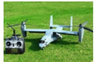
Il s'agit d'un hélicoptère à rotor contre-rotatif dont les axes de rotations sont séparés. La direction de la poussée peut être modifiée pendant le vol ce qui permet d'avoir les avantages de la voilure tournante en stationnaire et les avantages de la voilure fixe à vitesse élevée. Le [Osprey](#) est l'un de ces appareils. Ces modèles sont presque toujours électriques.
