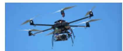
Au-delà de 4 rotors le fonctionnement ne change pas fondamentalement. Les rotors sont généralement par paire pour compenser le couple. On retrouve certains drones avec 3 branches mais 6 rotors montés tête-bêche.
