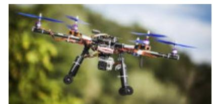
Avec 4 rotors le quadrirotor est plus stable. Pour orienter la poussée globale dans une direction il lui suffit d'augmenter la poussée dans la direction opposée et de la réduire ailleurs de manière à faire pencher le drone tout en conservant une poussée globale constante. Pour tourner sur lui-même, il augmente le couple provoqué par les hélices tournant dans un sens en les accélérant tout en décélérant les autres toujours pour conserver la poussée globale.
