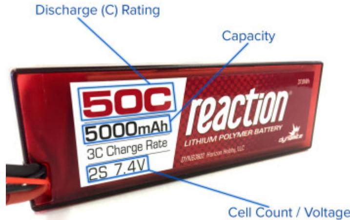
Il est aussi possible d'en placer en parallèle. Sur une batterie la configuration est renseignée. 2S signifie que la batterie est constituée de 2 éléments en série, 3S 3 éléments etc... On donne par la même occasion la tension puisqu'on sait que chaque élément fait 3.7V. Si des éléments sont en parallèle on aura par exemple 3S2P pour 3 éléments en série avec 2 éléments en parallèle mais c'est assez rare.
