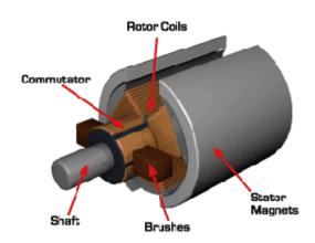
Dans le moteur brushed l'alimentation des bobines disposées autour du rotor dépendent de la position du rotor. Lorsque le rotor tourne la polarisation des bobines change ce qui créé le champ tournant.
