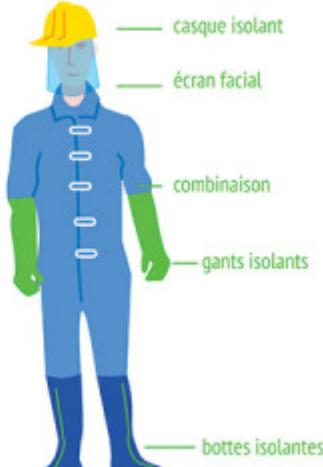
Les gants sont certifiés pour une certaine tension à condition de vérifier leur étanchéité avant chaque utilisation. Les bottes et le tapis vont encore isolé d'avantage du sol. Le masque de protection permet de protéger face aux émissions d'UV et de particules émis lors d'un arc électrique.
