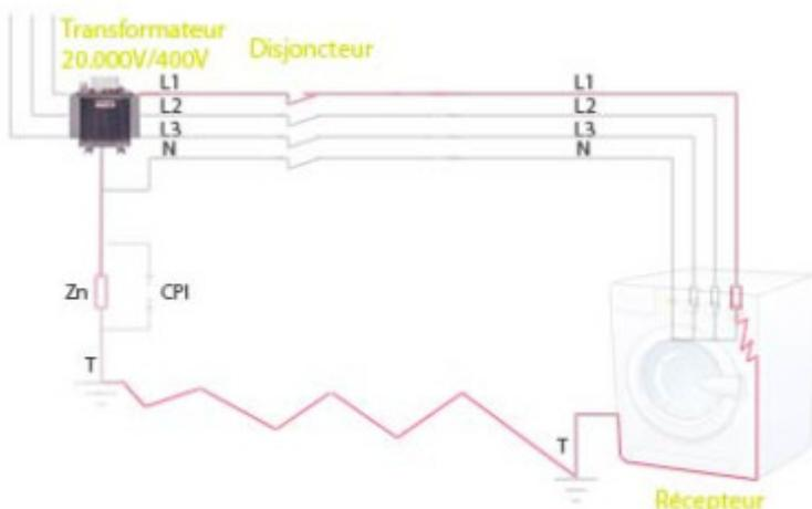
Cependant cela ne suffit pas à localiser le défaut. Pour cela il faut installer des détecteurs sur les différentes lignes et parfois tester toutes les lignes les une après les autres. Si le défaut est corrigé rapidement l'installation n'aura pas été arrêté. Mais si un second défaut apparaît ailleurs dans l'usine et sur une phase différente alors ces 2 phases seront reliées entre elles par le fil de terre ce qui créera un court-circuit et déclenchera les protections magnétiques.
