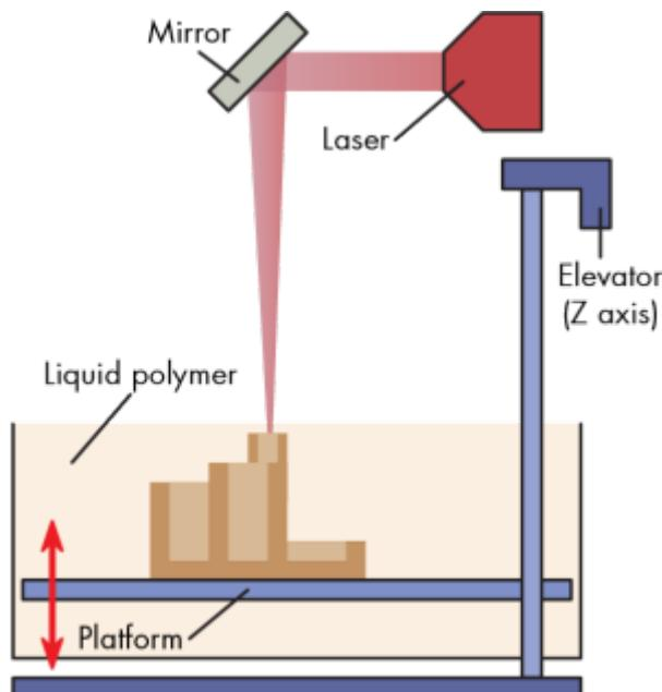
Le déplacement de la plateforme permet de créer l'objet couche par couche. Cette méthode est plus précise que celle utilisant le dépôt de filament (les technologies laser sont aujourd'hui très fiables), et évite d'avoir à chauffer le matériau (source de problèmes).
