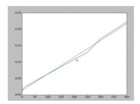
On a une belle fonction affine avec des trucs étranges proche de zéro. L'offset autour de zéro vient probablement du fait que les vérifications du while prennent un temps non-compressible. Pour le rapport cyclique, c'est à dire le rapport du temps où notre signal est haut et de la période, on a :
