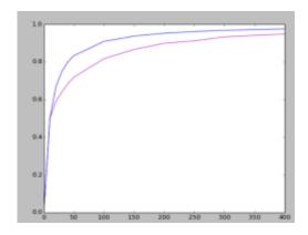
Le rapport cyclique mesuré est très différent du rapport cyclique théorique ( a/a+b ) On ne peut donc pas faire une boucle pour moduler en fréquence. D'autre part, quand on se rapproche d'un signal ayant une fréquence de celle de l'arduino (75kHz) la boucle n'est tout simplement pas efficace.
