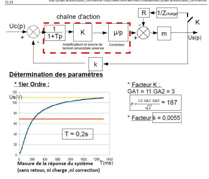
Divers diagrammes pour prouver la stabilité de mon système faits sous Scilab :
