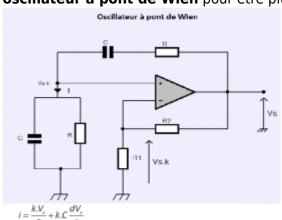
$$\Rightarrow (1-k)\frac{dV_z}{dt} = R\frac{d}{dt}\left(\frac{k.V_z}{R} + k.C\frac{dV_z}{dt}\right) + \frac{1}{C}\left(\frac{k.V_z}{R} + k.C\frac{dV_z}{dt}\right)$$
