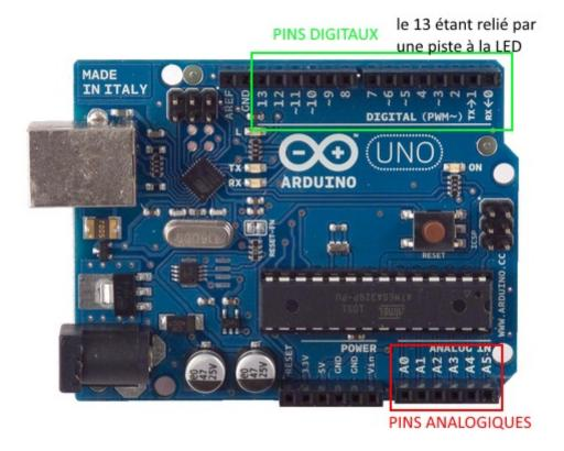
Les pins **analogiques** permettent une lecture de tension, une lecture d'état booléen ou une écriture d'état booléen (exemple : mettre la pin led à l'état HIGH).
