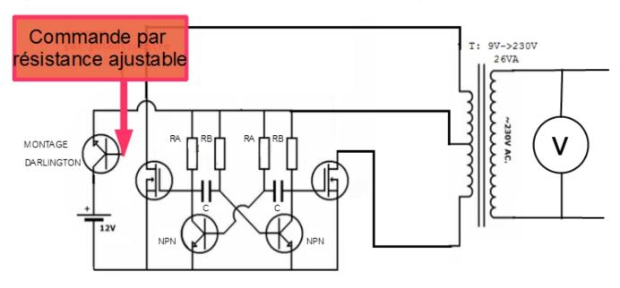
Ici, on remarque que le montage de l'oscillateur (multivibrateur astable) est simple (5 transistors, 2 condensateurs, 4 résistances...)
