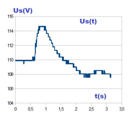
L'écart est dû au faible encodage de l'Arduino à 600mV et à mon oscillo... aussi!
