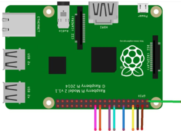
La raspberry pi est alimentée et interagit avec le système via son port de 2×20 pins, il faut un câble IDE (Parallel ATA) pour le relier avec le reste du système.
