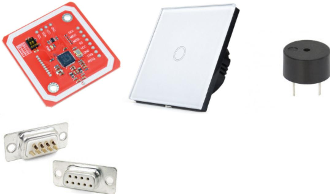
Le principe du lecteur est assez simple. Il doit envoyer au boîtier de traitement (via le connecteur DB9) l'UID de la carte lue. Si la carte est lue, le boîtier de traitement confirmera la lecture et l'accès (ou non) via le buzzer intégré.
