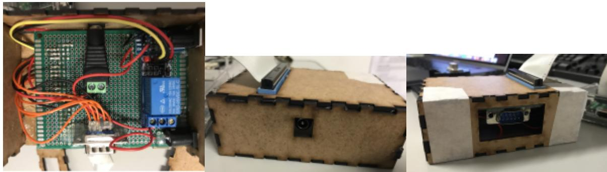
Il faut savoir que tout ce qui arrive sur le port DB-9 est directement redirigé vers le port IDE male, le boîtier de traitement n'effectuant pas de traitement en somme (il n'y a pas de microcontrôleur dans ce boîtier), il est juste une sorte de boîtier "agrégateur" sur lequel on branche tous les éléments du système pour qu'ils puissent communiquer entre eux.
