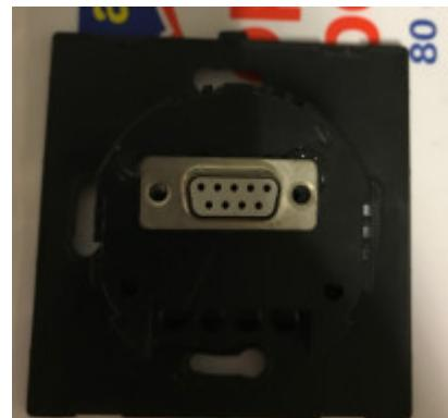
Enfin, il faut tout faire rentrer dans l'arrière du boîtier et souder les sorties SPI du lecteur, l'alimentation du lecteur et le buzzer sur le connecteur DB9. Vous trouverez ci dessous un schéma détaillé. (notez qu'ici le lecteur est bleu, mais les connexions sont bonnes et identiques à celui du PN532 rouge)
