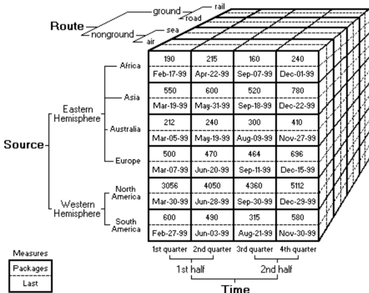
La structure de cube de données est adaptée pour la réalisation d'histogramme multidimensionnels, selon les axes choisis et le niveau de résolution choisi, à l'aide de fonctions d'aggrégation.
