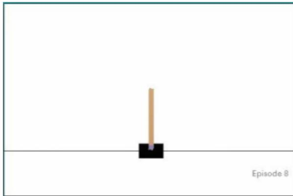
Une barre rigide est attachée par une charnière à un chariot, qui bouge le long d'un rail sans friction.
